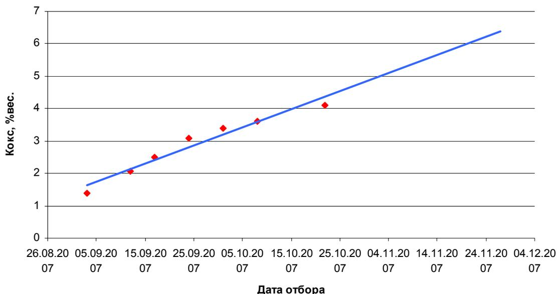
Рис. 5.7. Зависимость количества кокса на катализаторе от срока эксплуатации
