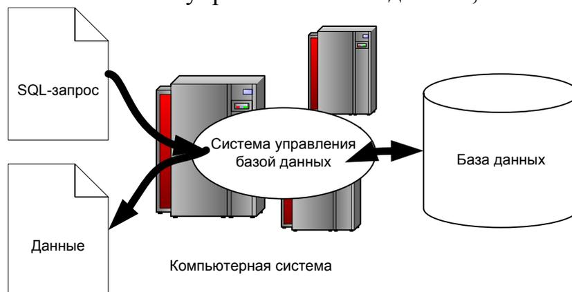
Рис. 7.4. Применение SQL для доступа к базе данных
