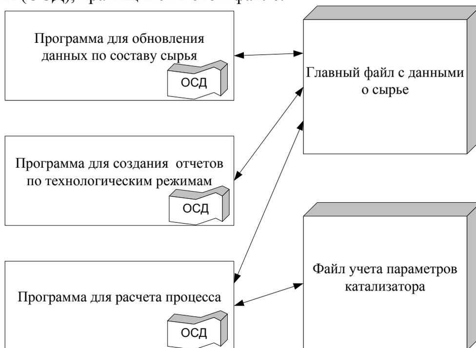
Рис. 7.1. Приложение для расчета процесса, использующее систему управления файлами
