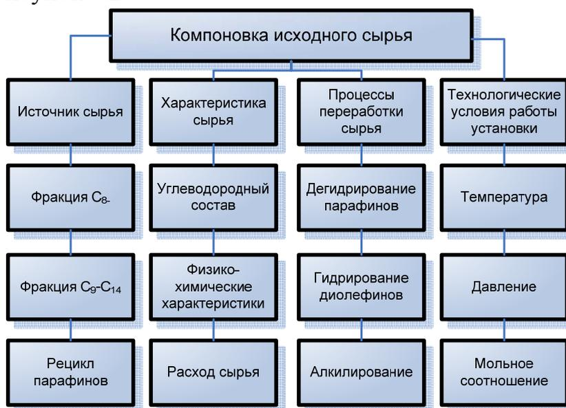
Рис. 7.2. Иерархическая база данных, содержащая информацию о компоновке исходного сырья
