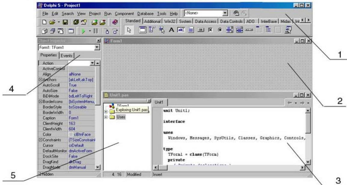
Рис. 6.1. Наиболее важные окна Delphi: 1 – главное окно; 2 – окно формы; 3 – окно кода программы; 4 – Окно Инспектора Объектов; 5 – окно браузера.
