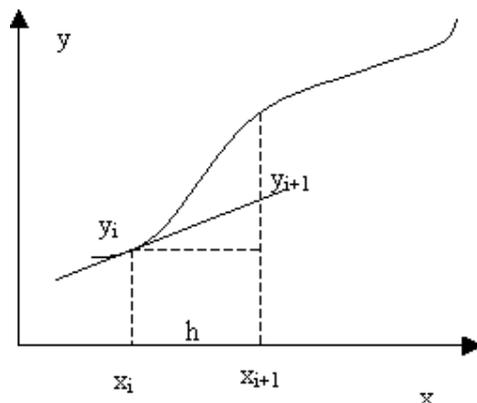
Рис.4.1. Графическая иллюстрация метода Эйлера
