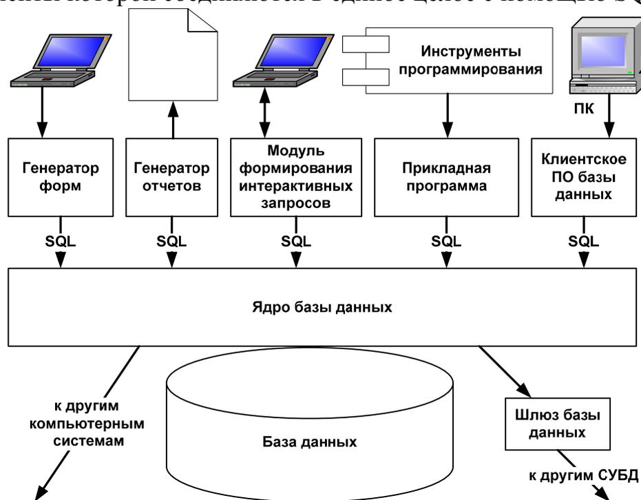
Рис. 7.5. Компоненты типичной СУБД
