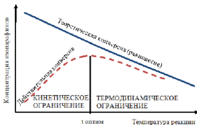
Рис. 7.1. Зависимость конверсии n -парафинов от температуры реакции
