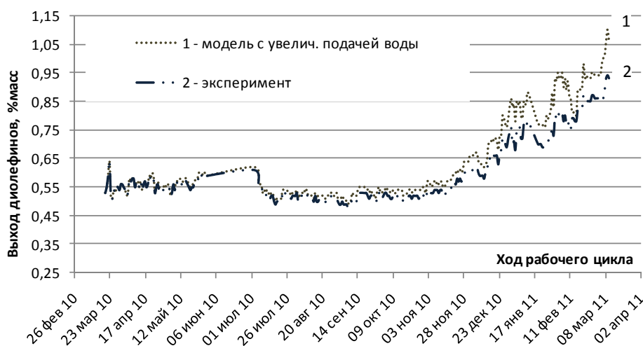
Рис. 9.26. Концентрация олефинов при различных режимах подачи воды: постоянными и увеличивающимися порциями
