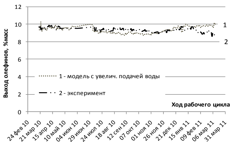
Рис. 9.26. Концентрация олефинов при различных режимах подачи воды: постоянными и увеличивающимися порциями
