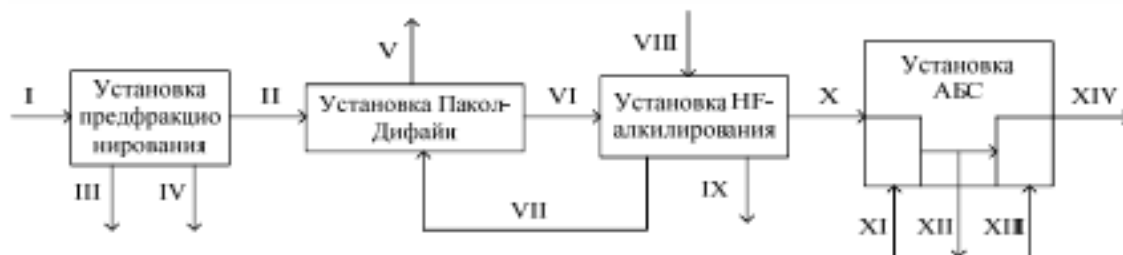
Рис. 9.1. Блок-схема потоков комплекса производства ЛАБ, ЛАБС:
