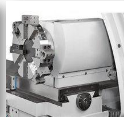
Инструментальная головка на 8 инструментов с внутренней подачей СОЖ.
