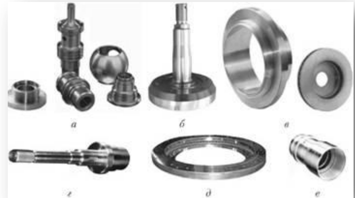
Рис. 1 Типовые детали полученные токарной обработкой с ЧПУ: а – детали типа втулок; б – деталь Т-образной формы; в – детали типа дисков, фланцев; г – ступенчатый вал; д – крупногабаритная кольцевая деталь; е – тонкостенная оболочка
