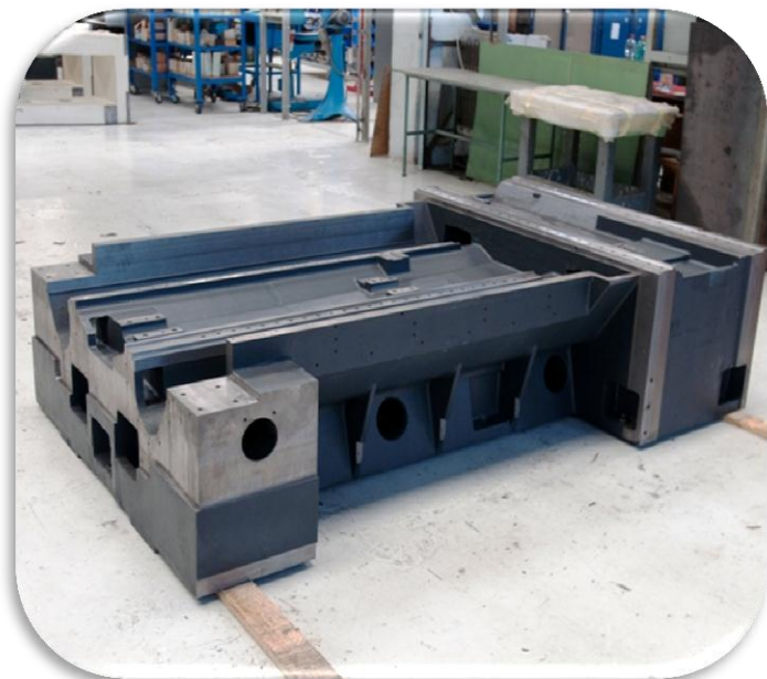
Рисунок 2 Станина горизонтально-фрезерного обрабатывающего центра H50 на заводе-изготовителе TAJMAC-ZPS (Чехия)
