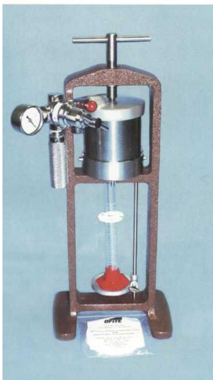
Рис.5.14. Фильтр-пресс настольный с модулем давления \text{CO}_2 (слева). Прибор КТК-2 (справа)
