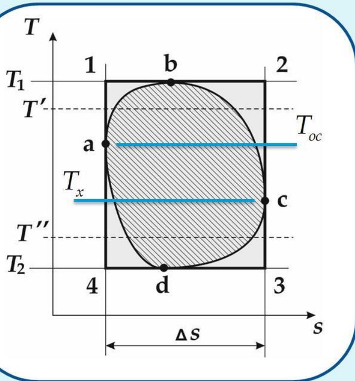
$$q_1 = q_{1 \rightarrow 2} = T_1 \Delta s \quad |q_2| = |q_{3 \rightarrow 4}| = T_2 |\Delta s|$$
