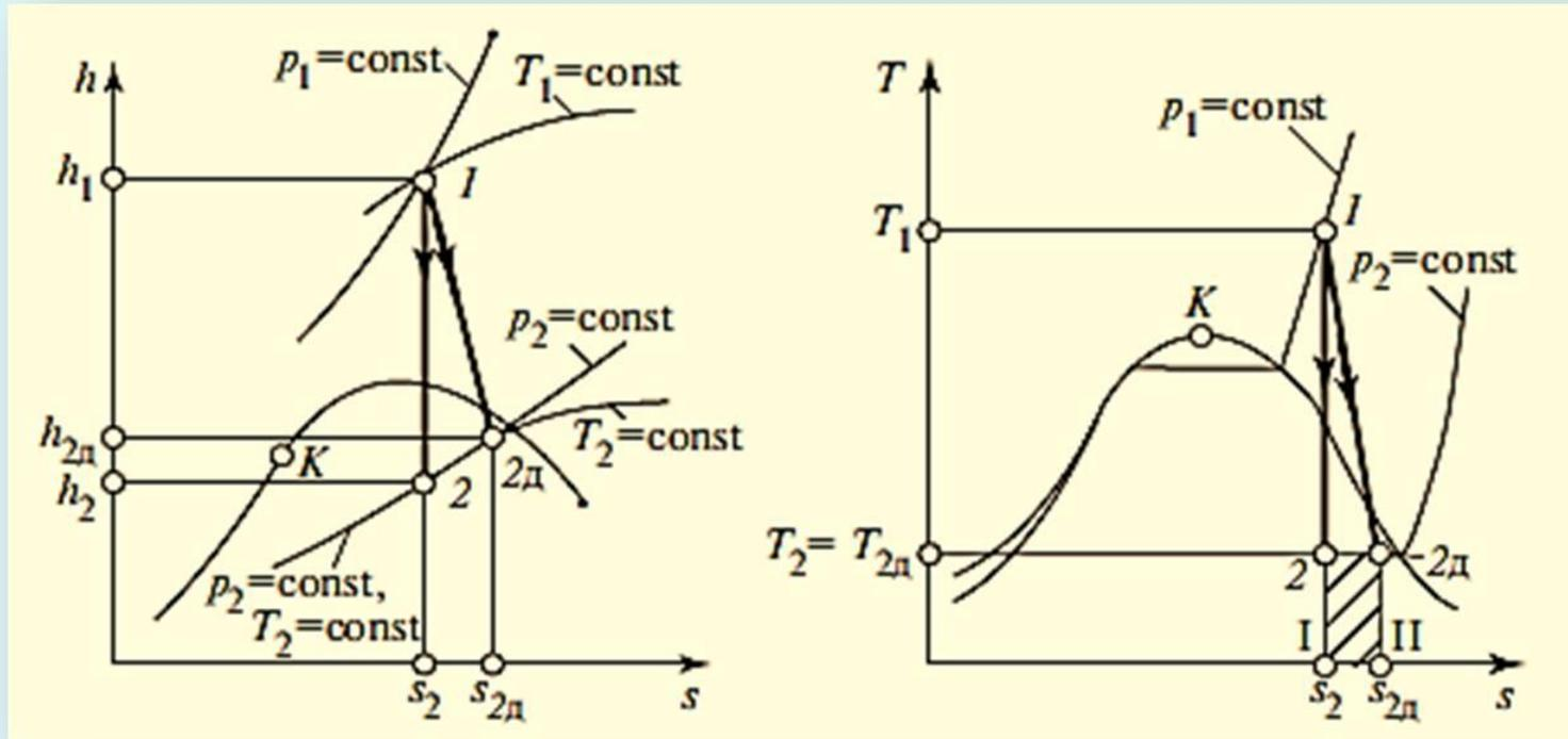
Внутренний относительный КПД турбины –  $\eta_{oi}^T = \frac{l_{\partial}}{h_1 - h_2} = \frac{h_1 - h_{2\partial}}{h_1 - h_2}$
