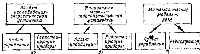
Рис 101 Структурные схемы натурального эксперимента (а), физического (б) и математического (в) моделирования
