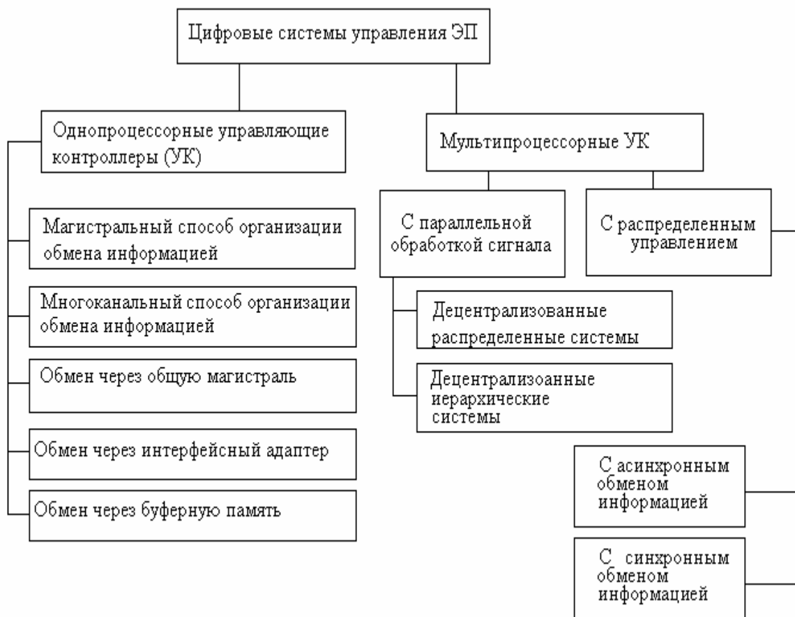
Рис. 1.2.1. Классификация цифровых систем управления электроприводами
