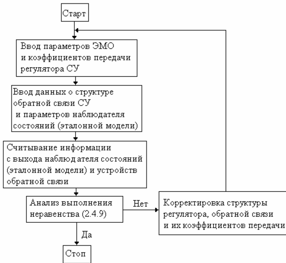
Рис.2.4.1.Блок-схема алгоритма функционирования переключающего устройства
