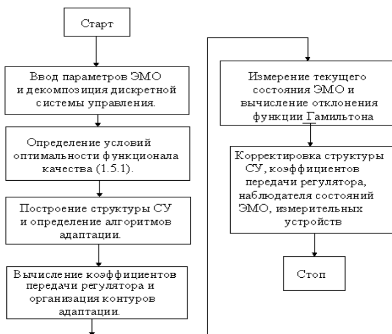
Рис. 2.1. Блок-схема выполнения этапов алгоритмического конструирования адаптивных СУ ЭМО
