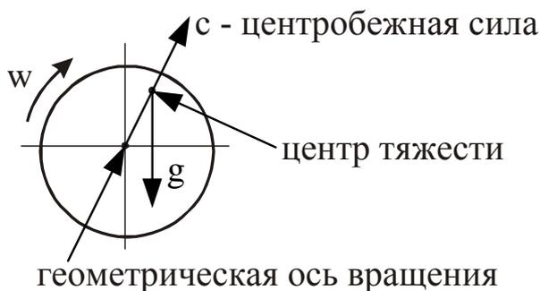
Рис. 8.1. Схема смещения центра тяжести от оси вращения в плоском диске.
