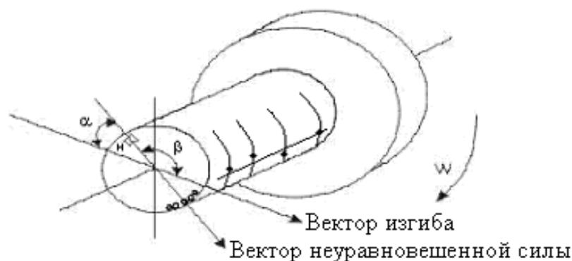
Рис. 8.6. Схема динамической балансировки.
