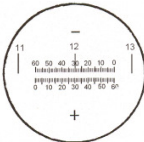
Рис. 9 Пример снятия отсчета с КО-30
