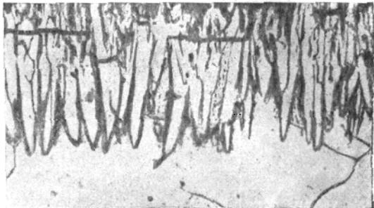
Рис.13. Микроструктура борированного слоя на железе; x400
