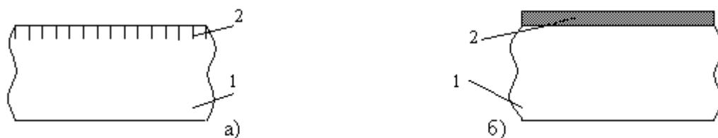
Рис. 2. Структура упрочненной поверхности, полученная за счет модифицирования (а) и при нанесении покрытия (б); 1 – основной
