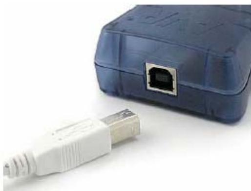
Когда AVRISP mkII, подключен к PC, и если USB драйвер установлен, то зеленый светодиод, находящийся в AVRISP mkII близко к разъему USB будет зажжен. До того, как устройство будет определено, светодиод горит красным. После того как AVRISP mkII подключен к PC, он может быть подключено к устройству. Красная полоса на целевом кабельном штырьке отмечает ISP 1, и это должно соответствовать 1 в разъеме ISP на плате.
