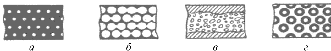
Рис. 19. Типы структур газосодержащих полимеров: а – закрытопористая; б – открытопористая; в – интегральная; г – синтактная (с полыми наполнителями)
