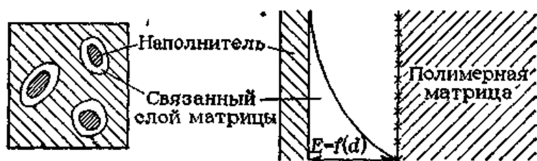
Рис. 24. Схема композита, полученного смешением (слева) и методом полимеризационного наполнения (справа)
