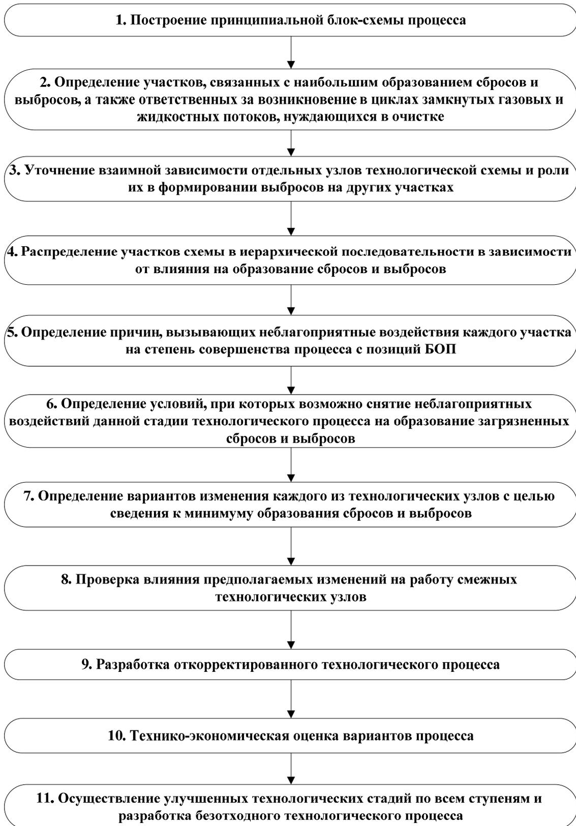
Рис. 37. План-график анализа технологической схемы
