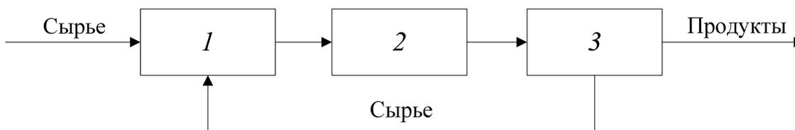
Рис. 42. Блок-схема реактора с рециклом сырья после разделения:
