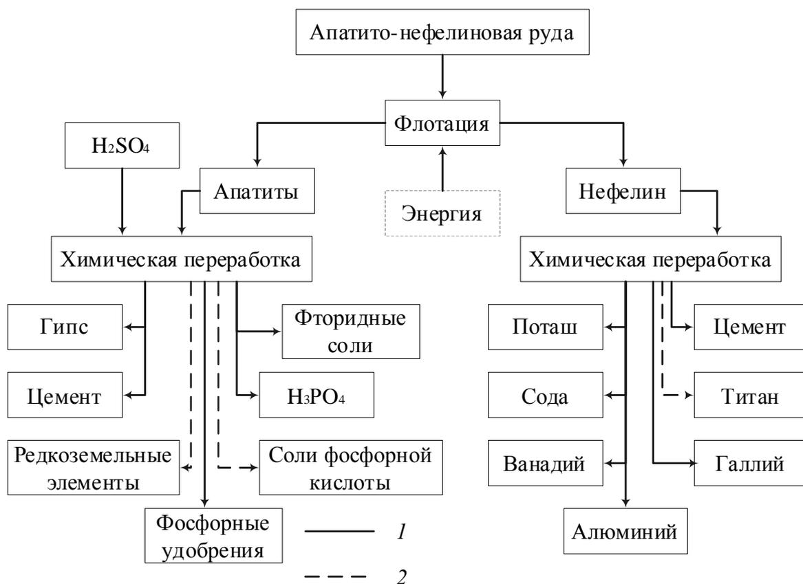
Рис. 15. Схема комплексного использования апатито-нефелиновой породы:
