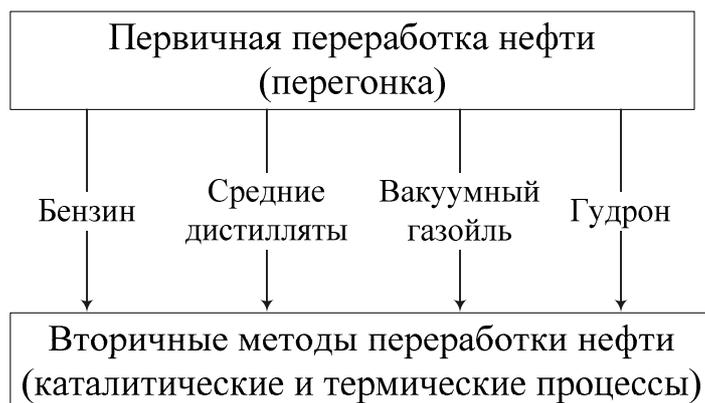
Рис. 16. Схема переработки нефти
