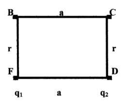
Определить работу электрических сил при перенесении заряда  $\mathbf{q=1}$  нКл из точки  $\mathbf{B}$  в точку  $\mathbf{C}$  (см. рис.), если  $\mathbf{r=6}$ см,  $\mathbf{a=8}$ см,  $\mathbf{q_1=3,33\cdot10^{-9}}$  Кл  $\mathbf{q_2=-3,33\cdot10^{-9}}$  Кл.
