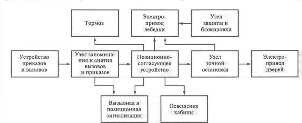
Рис. 2.42. Структурная схема лифтовой установки
