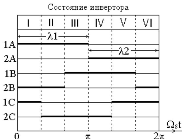
Рис. 2.19. Диаграмма состояний ключей инвертора
