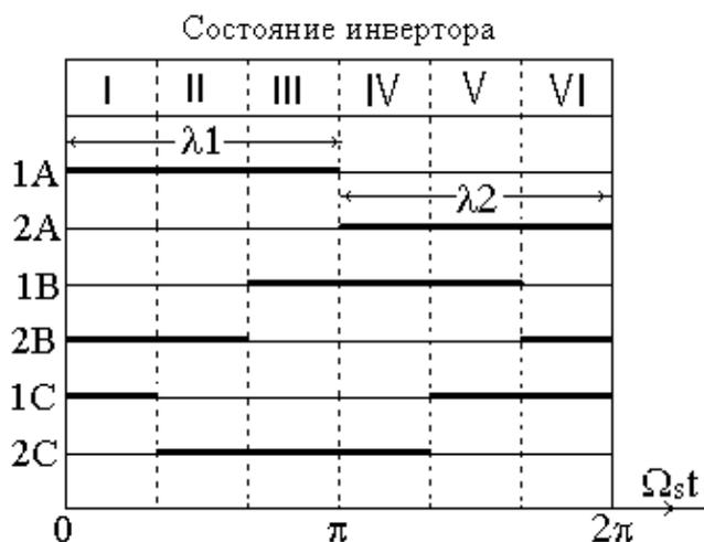
Рис. 4.4 Диаграмма состояний ключей инвертора
