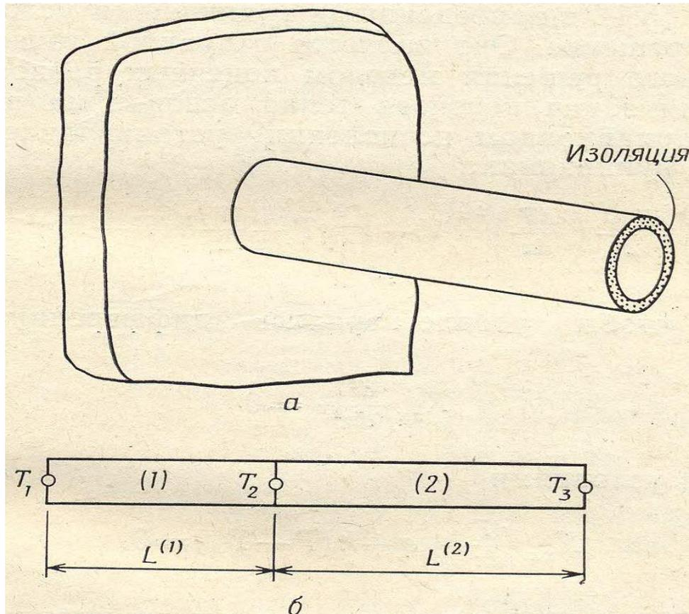
К закреплённому в стене концу стержня подводится тепловой поток заданной интенсивности  $q$ .
