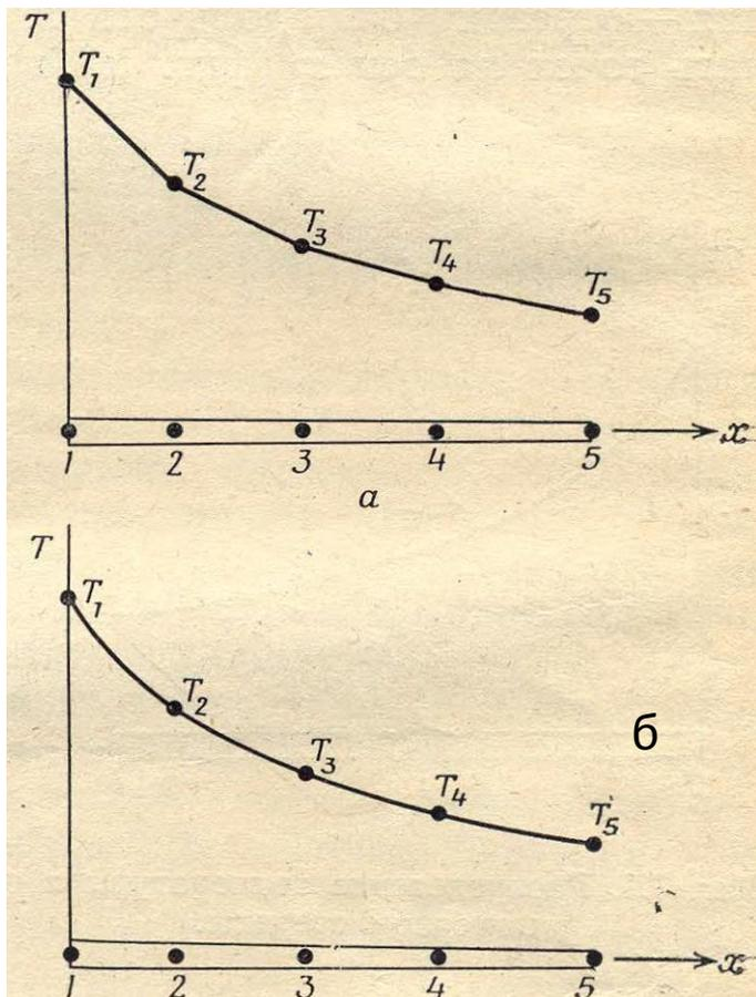
В случае разбиения области на четыре элемента на каждый элемент приходится по два узла, функция элемента будет линейна по  $x$ .
