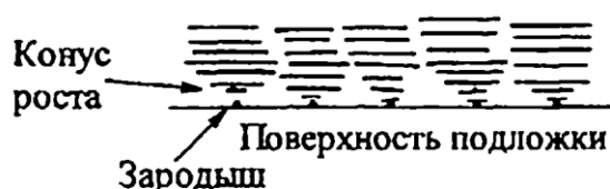
Рис. 1.6. Образование пленки пироуглерода на поверхности подложки
