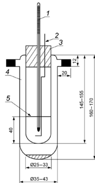
1 - термометр; 2 - мешалка; 3 - пробка; 4 - пробирка; 5 - кольцевая метка
