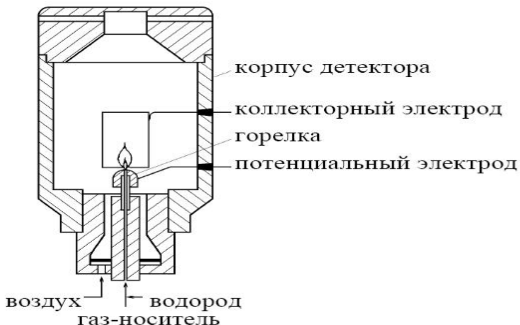
Рисунок 4 – Схема устройства пламенно-ионизационного детектора: горелка (называемая соплом), питаемая смесью водорода и газа – носителя с постоянной объемной скоростью потока и окруженная электродами
