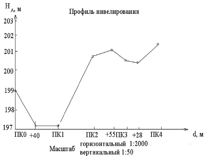
Рис. 20. Профиль нивелирования (Передерин В.М. [9]).
