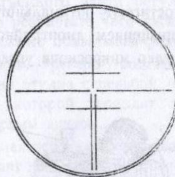
Рис. 2. Сетка нитей зрительной трубы
