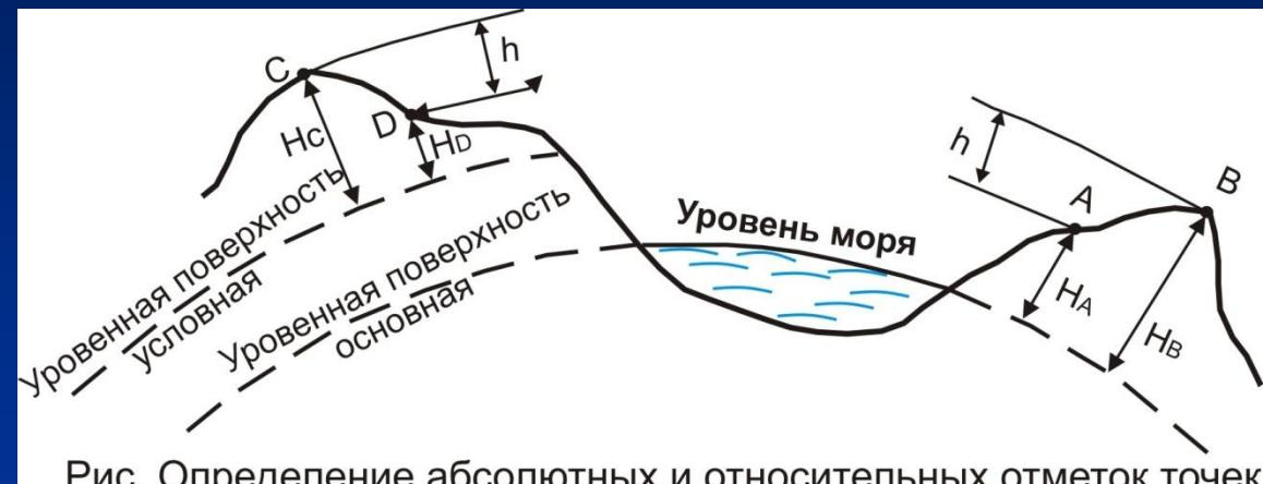
Рис. Определение абсолютных и относительных отметок точек
