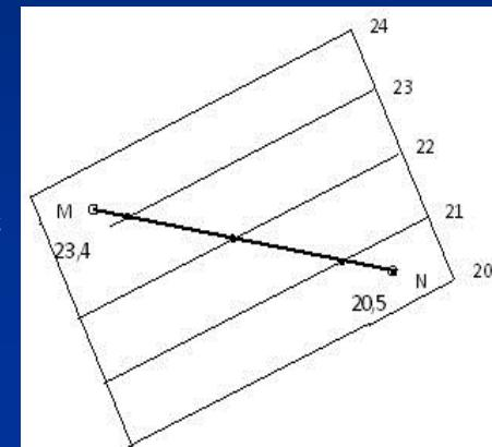
Рис. Графическое интерполирование горизонталей с помощью палетки
