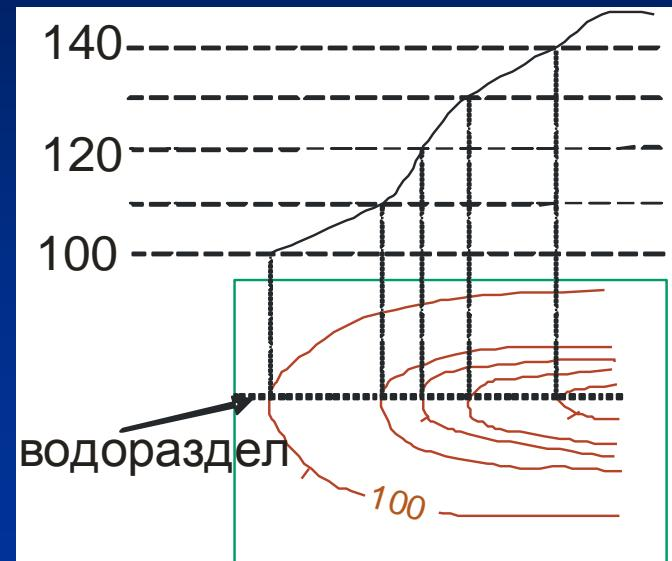
**Хребет** - возвышенность, вытянутая в одном направлении, скаты которой при пересечении в верхней части образуют водораздел или водораздельную линию. Чтобы отличить хребет от лощины необходимо также смотреть **бергштрихи** и искать оцифрованные горизонтали.
