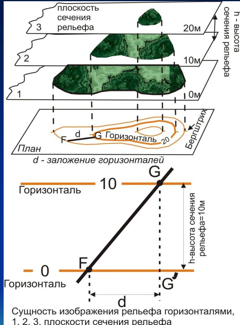
Горизонтали всегда проводят кратными принятой высоте сечения рельефа. Для лучшего чтения рельефа часть горизонталей вычерчивают утолщенной линией (0,2 мм против 0,1 мм у остальных горизонталей): У утолщенных горизонталей **выписывают** их отметки, располагая цифры в разрывах горизонталей так, чтобы их верх был направлен в сторону возвышения.
