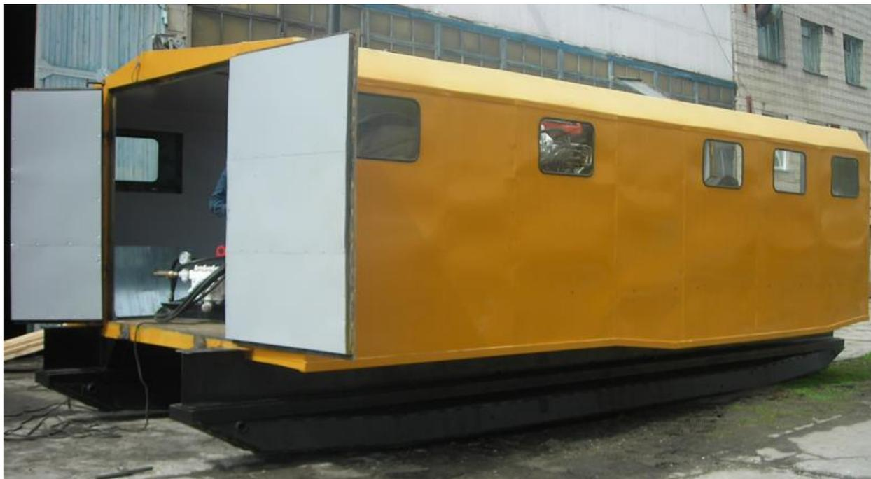
❖ Структурно установка **ПБУ-800ПГП** аналогична установке **ПБУ-1200ПГП**. Буровая установка состоит из пневмогидравлической платформы, бурового здания, мачты, гидросистемы, электрооборудования, пневмосистемы. На платформе монтируются буровое здание, мачта, гидроподъемник, мосты и цилиндры, органы управления гидросистемой, тормозная система. Буровое здание цельнометаллическое с наружной обшивкой листовой сталью, утепленное, с внутренней отделкой фанерой и пластиком.
