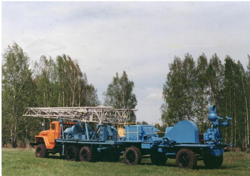
**Самоходная буровая установка 1БА-15В предназначена для бурения вращательным способом с прямой промывкой забоя вертикальных скважин глубиной до 1000 м для водоснабжения с последующим оснащением и пробной откачкой воды а также для бурения геотехнологических скважин. Установка применяется в умеренной климатической зоне, в доступных для автотранспорта районах.**
