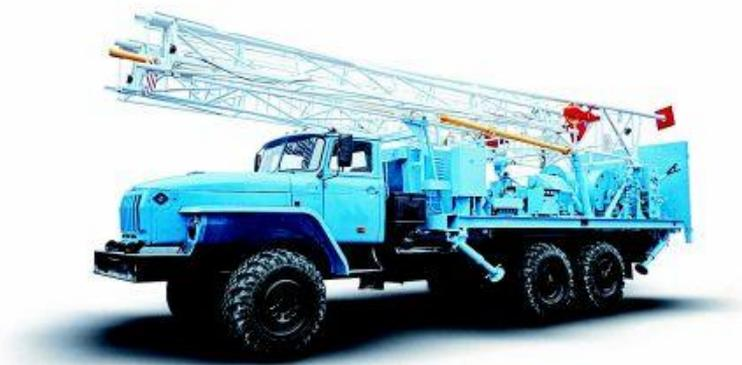
❖ для бурения геотехнологических скважин глубиной до 500 м по своим техническим характеристикам наиболее полно соответствуют унифицированные буровые установки УРБ-3А3.02, УРБ-3А3.13 и УРБ-3А3.051.
