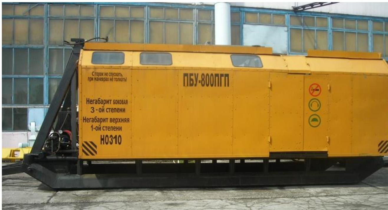
❖ используется для бурения поисково-разведочных и геотехнологических вертикальных и наклонных скважин глубиной до **800** м в равнинных, лесостепных и горно-таежных районах.
