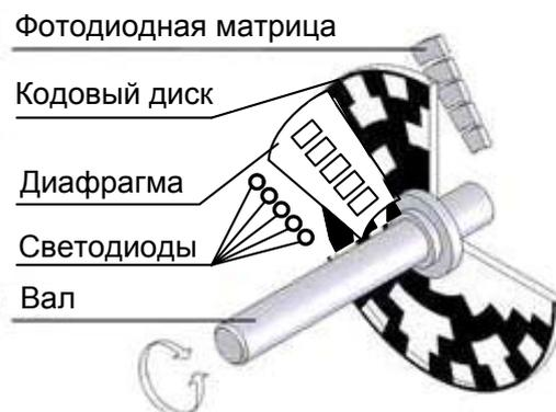
Рис. 7. Устройство однооборотного энкодера
