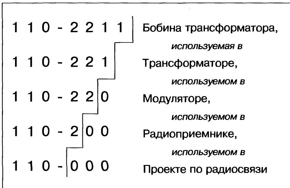
Рис. 4.3 Пример системы кодирования для производственного проекта В этом примере была наугад выбрана бобина трансформатора, используемая в производственном проекте, система нумерации которой была показана на рис. 4.2. Анализ показывает, каким образом часть номера bobины действует как код, который помещает этот компонент на правильную ветвь генеалогического дерева. Самое большое преимущество от использования таких систем родовой нумерации можно получить, когда шифры компонента, номера чертежей и коды расходов являются частями одной системы.
