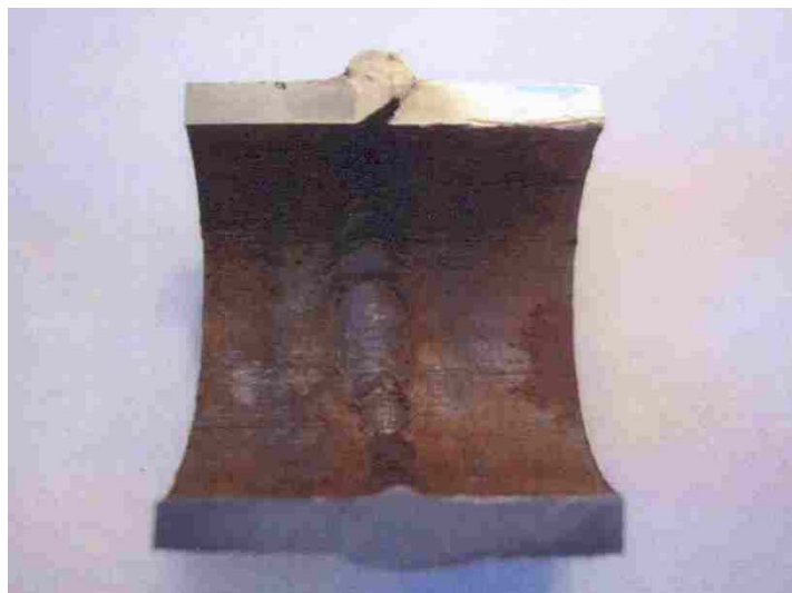
Рис. 1.2. Поперечный разрез трубы с дефектным швом
