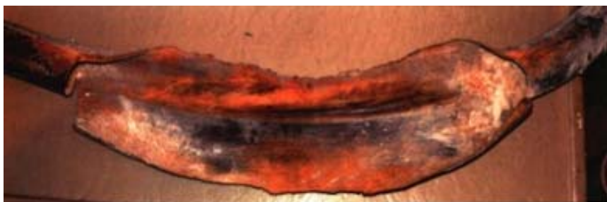
Рис.1.5. Общий вид продольного разрыва поврежденной трубы
