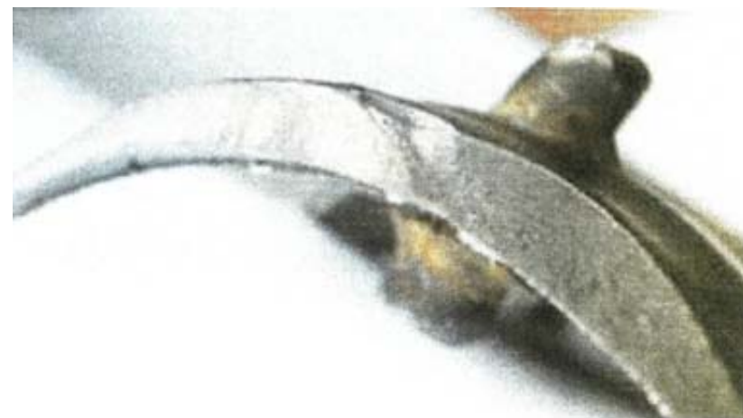
Рис. 1.17. Поверхность разрушения лопатки
