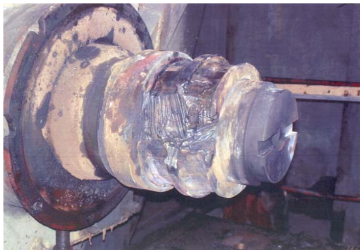
Рис. 1.35. Повреждение подшипника. Вид с торца
