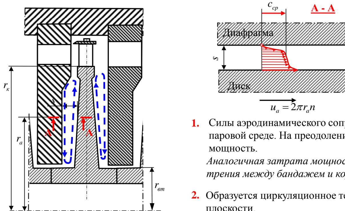
1. Силы аэродинамического сопротивления вращению диска в паровой среде. На преодоление этих сил затрачивается мощность.
