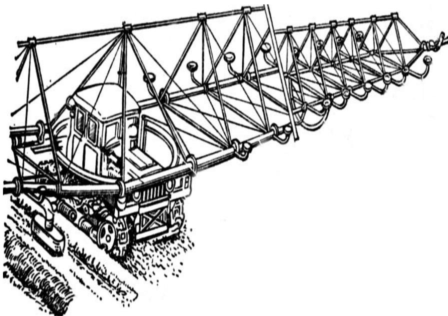
*Рис. 11.* Двухконсольный дождевальный короткоструйный агрегат ДДА-100МА
