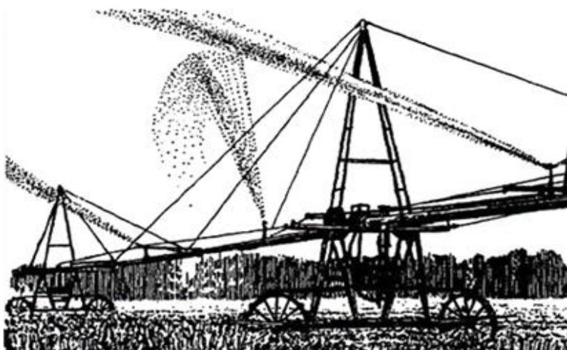
Рис. 12. Самоходная дождевальная среднеструйная многоопорная машина «Фрегат»
