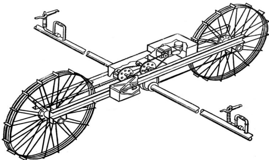
Рис. 13. Самоходная дождевальная среднеструйная многоопорная фронтальная машина ДКШ-64 «Волжанка»
