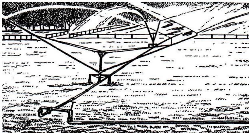
*Рис. 14.* Дождевальный шлейф ДШ-25/300 карусельного типа
