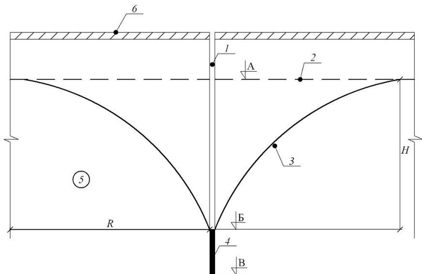
Рис. 22. Схема конструкции вертикального трубчатого дренажа:
