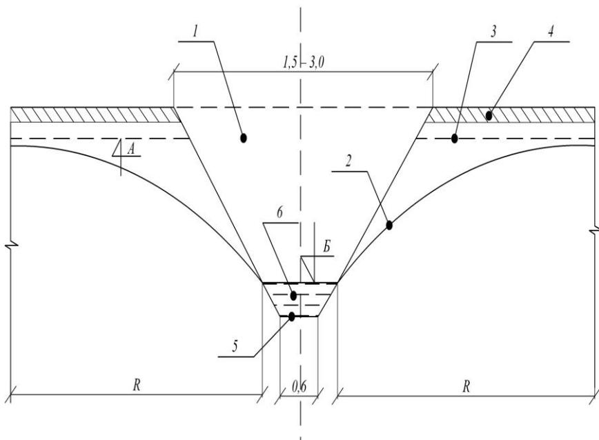
Рис. 20. Конструкция горизонтального дренажа открытого типа:
