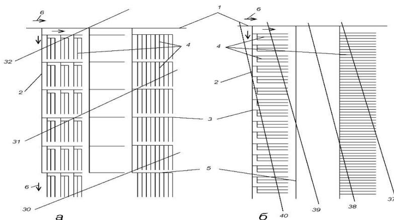
*Рис. 6.* Схема расположения временной оросительной сети поливом по бороздам: *a* – продольная; *b* – поперечная; 1 – распределительные каналы; 2 – временные оросители; 3 – распределительные борозды; 4 – поливные борозды; 5 – выводные борозды; 6 – направление движения воды; 30–32, 37–40 – горизонталы
