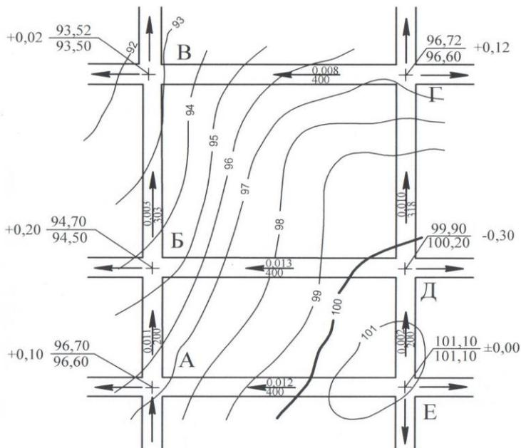
Рис. 8. Фрагмент схемы вертикальной планировки территории кварталов микрорайона
