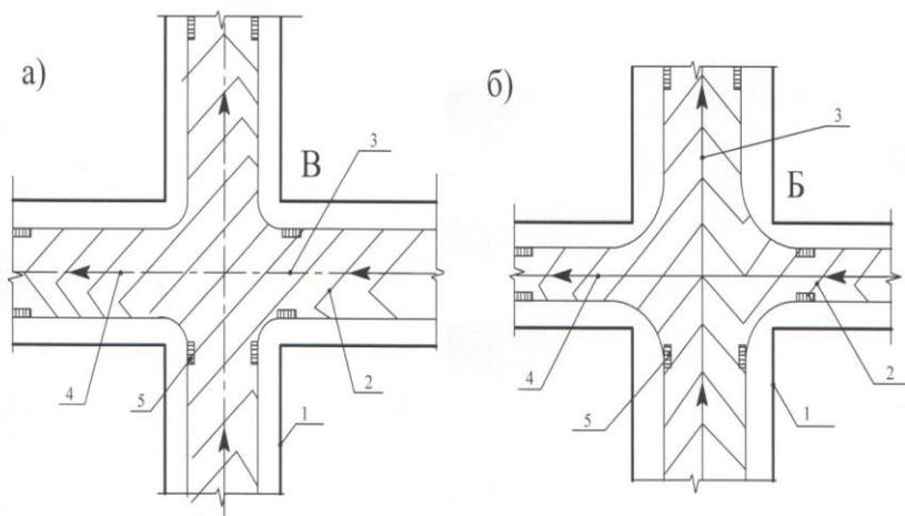
Рис. 17 Вертикальная планировка перекрестка, расположенного на косогоре (применительно к перекресткам Б и В (см. рис. 8)).
