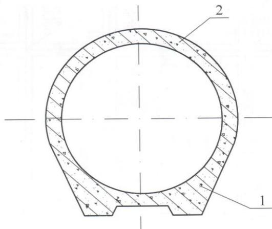
Рис. 26. Железобетонная труба с плоской подошвой
