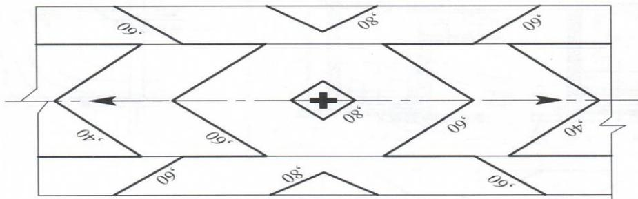
Рис. 16. Вертикальная планировка участка улицы в точках выпуклого перелома проектной линии (водораздела). Применительно к перекрестку на улице В-Г (см. рис. 8). Обозначения – приведены в соответствии с рис. 15.
