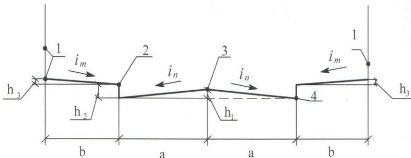
Рис. 11. Поперечный профиль улицы
