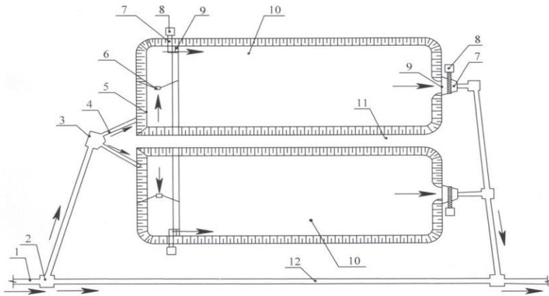
Рис. 28 Схема очистного сооружения открытого типа (пруд-отстойник)
