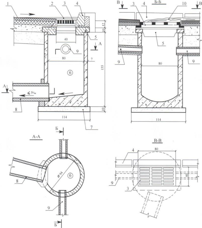
Рис. 24. Сборный железобетонный дождеприемный колодец
