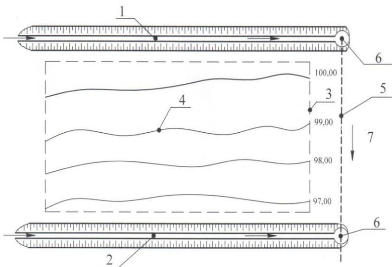
Рис. 3. Схема защиты территорий от воды путем ее перехвата нагорными канавами
