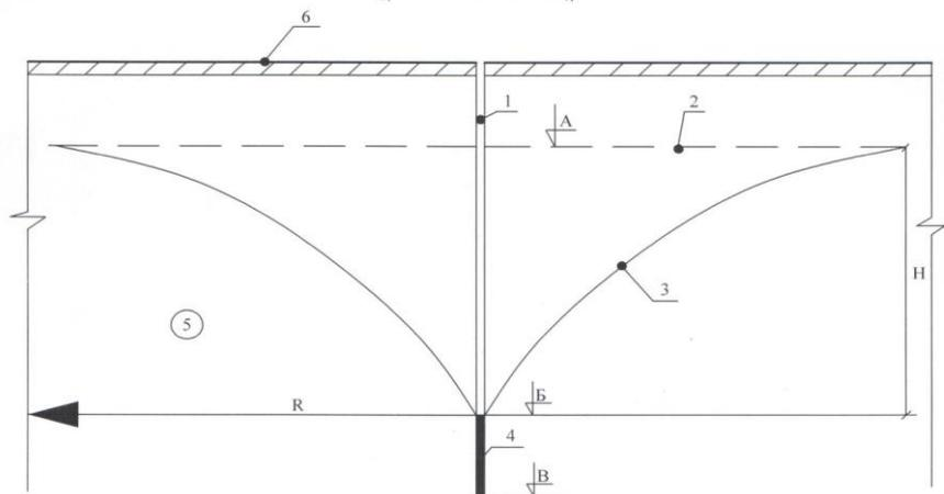
Рис. 6. Схема конструкции горизонтального трубчатого дренажа закрытого типа 1 – скважина (колодець); 2 – горизонт (уровень) грунтовых вод до понижения уровня; 3 – депрессивная кривая; 4 – вода, подлежащая удалению из водопримемной части скважины; 5 – грунт осушения; 6 – почвенный покров; Н – высота понижения уровней грунтовых вод; А Б – соответствующие высотные отметки грунтовых вод до и после дренирования; В – отметка для скважины; R – радиус депрессионной воронки.
