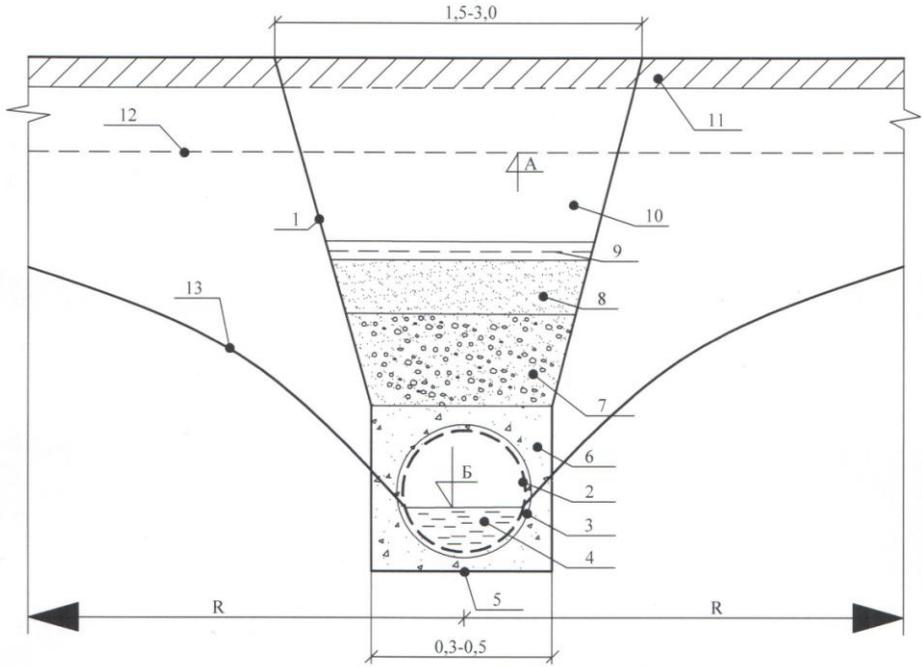
Рис. 5. Конструкция горизонтального трубчатого дренажа закрытого типа
