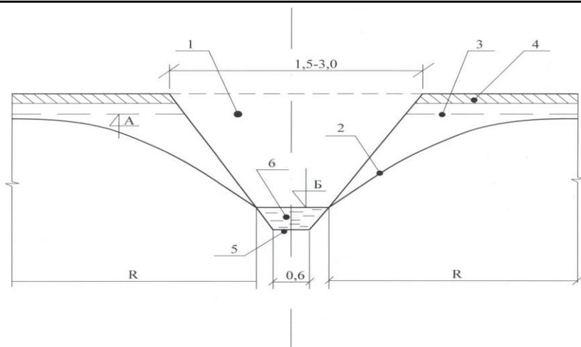
Рис. 4. Конструкция горизонтального дренажа открытого типа
