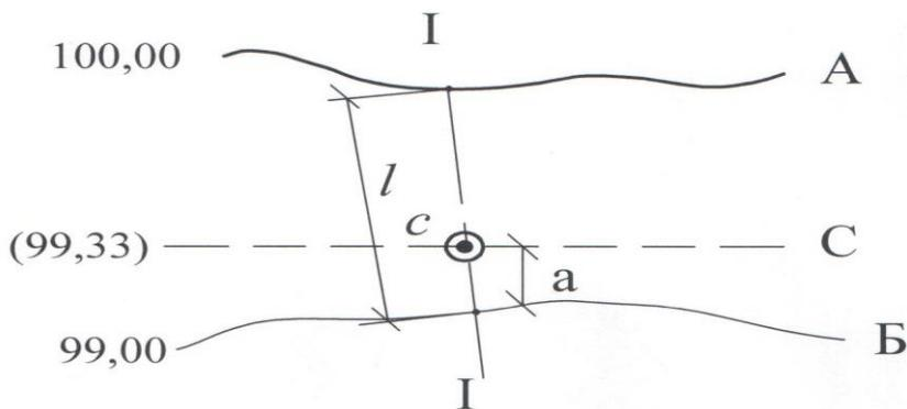
Рис. 7 Расчетная схема для определения высотной отметки точки «С» на топографическом плане
