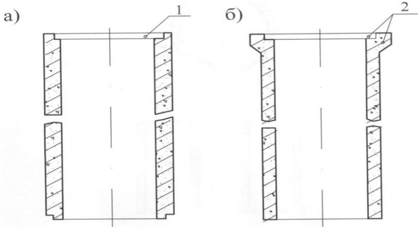
Рис. 25. Железобетонные трубы для водостоков
