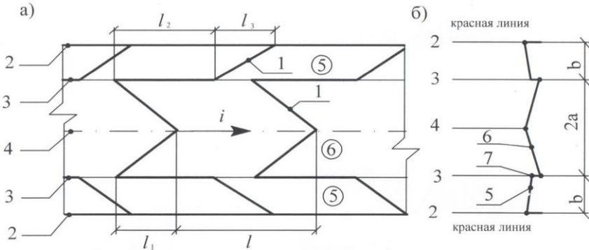
Рис. 12. Фрагмент вертикальной планировки улицы методом проектных горизонталей
