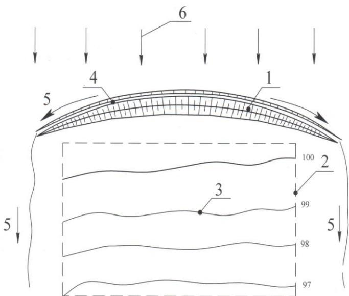
Рис.2 Схема обваловки защищаемой территории от воды
