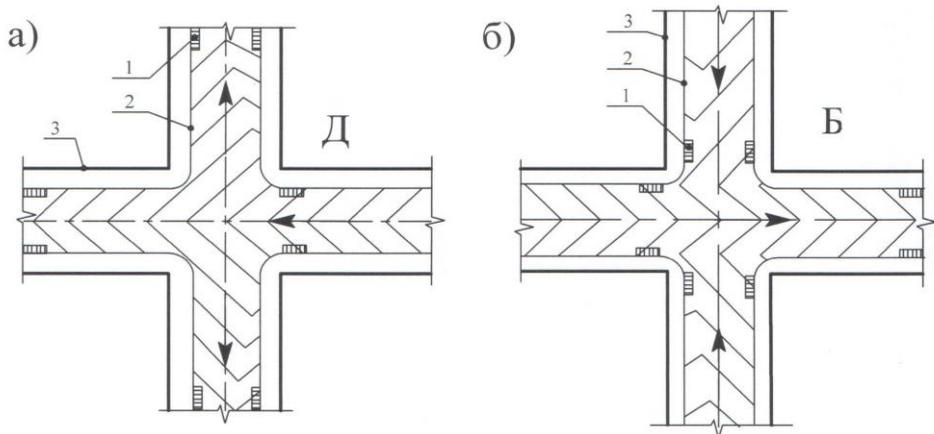
Рис. 18 Вертикальная планировка перекрестка расположенного на: а) водоразделе; б) на тальвеге (применительно к перекресткам Б и Д, см. рис. 8).
