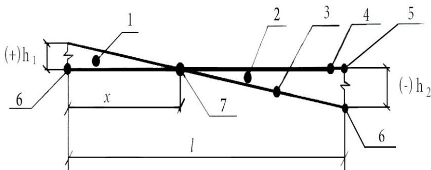
Рис. 9. Расчетная схема определения положения точек нулевых работ
