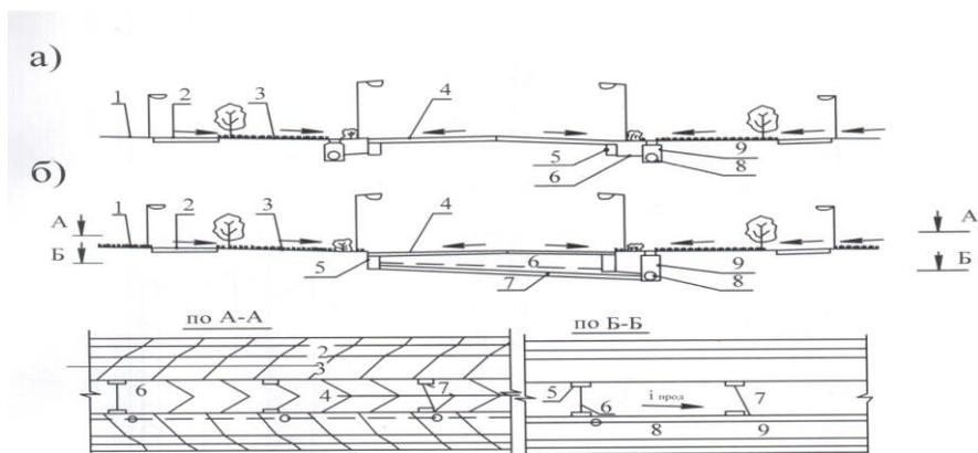
Рис. 23. Схема расположения водостока на улице
