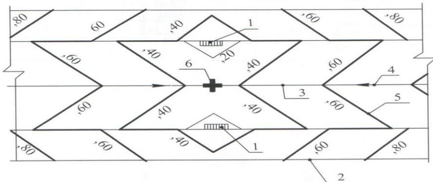
Рис. 15. Вертикальная планировка улицы в точках вогнутого перелома продольного профиля:
