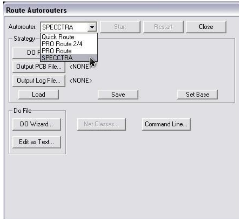
Рис. 42. Запуск системы SPECCTRA из меню команды Route/Autorouters
