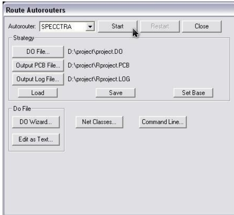
Рис 44. Окно команды Route/Autorouters для SPECCTRA после создания управляющего файла
