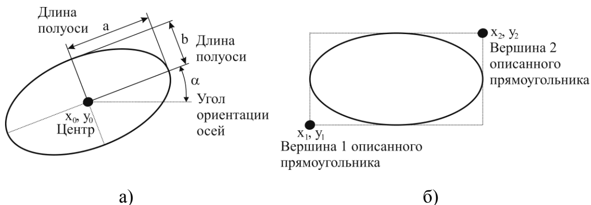
Рис. 38. Способы задания эллипсов: а) по центру, полуосям и углу ориентации осей; б) описанным прямоугольником
