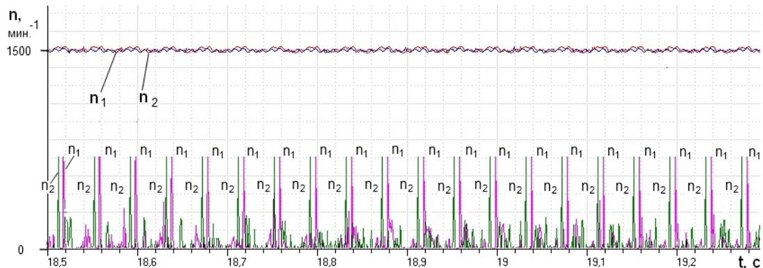
Рисунок 8 - Запись частот вращения и импульсов отметчика оборотов ведущего вала n_1 и ведомого вала n_2 муфты в установившемся режиме
