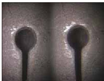
Рис. 7.10. Пример хороших условий для стереоскопического измерения
