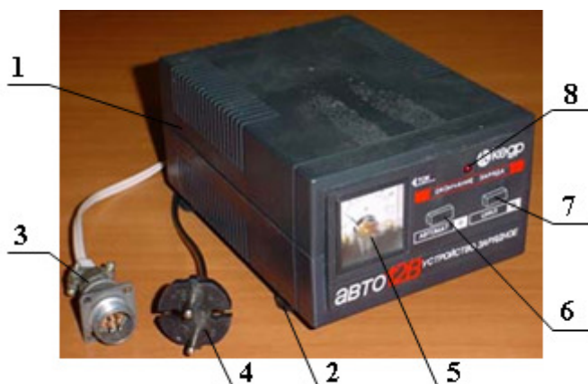
Рис. 1.9. Зарядное устройство «КЕДР-АВТО»: 1 – корпус; 2 – ножки; 3 – кабельная вилка; 4 – вилка сетевого шнура сети 220 В, 50 Гц; 5 – стрелочный индикатор тока (амперметр); 6 – кнопка режима «АВТОМАТ»; 7 – кнопка режима «ЦИКЛ»; 8 – световой индикатор
