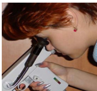
Рис. 1.12. Управление изгибом конца рабочей части эндоскопа
