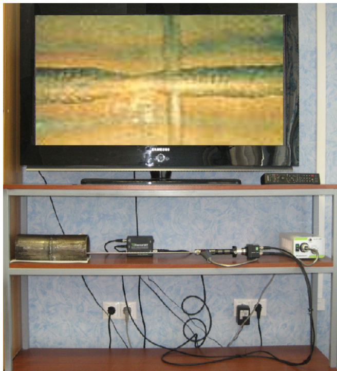
Рис. 4.17. Видеосистема с жестким эндоскопом с качающейся призмой
