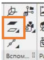
Указать *Базовую плоскость* – кликнуть один раз ЛКМ на синей плоскости XY. Появится черный контур новой плоскости.
