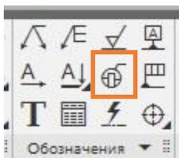
В панели управления появятся параметры выносного элемента где можно назначить его точку вставки, форму контура и его размеры, обозначение и направление полки под текстом. Оставить все без изменений.
