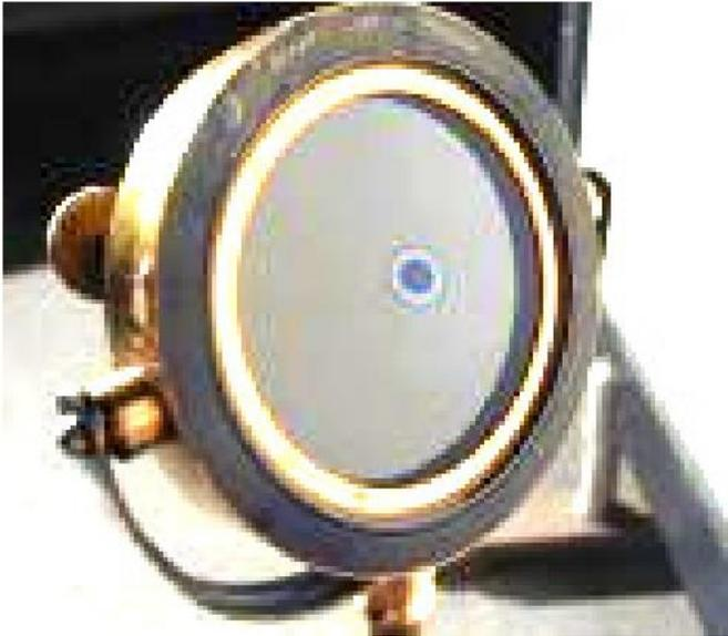
Кольцевые полосы равной толщины, наблюдаемые в воздушном зазоре между соприкасающимися выпуклой сферической поверхностью линзы малой кривизны и плоской поверхностью стекла, называют **кольцами Ньютона**.
