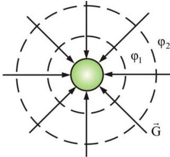
Линии напряженности  $G$  и эквипотенциальные поверхности  $\varphi_1$  и  $\varphi_2$  гравитационного поля
