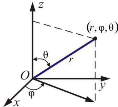
Рис. Сферическая система Координат
