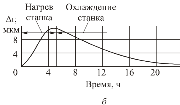
Рис. 4.35. Зависимости температурных смещений конца шпинделя токарного станка от времени нагрева (работы) и охлаждения [2]: a – в вертикальной плоскости; б – в горизонтальной плоскости
