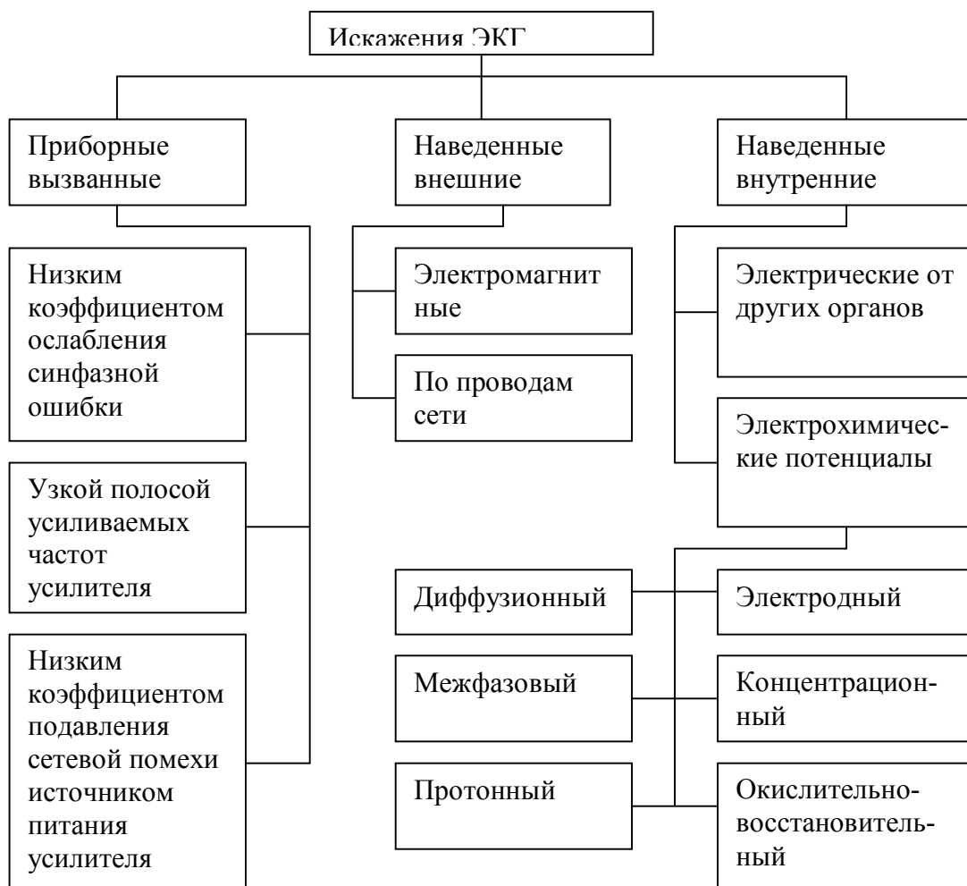
Рис.11. Причины и источники наводок при регистрации ЭКГ
