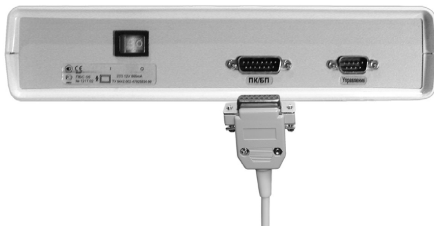
Рис. А 2. Задняя панель преобразователя биосигналов и 16-pin разъем блока питания
