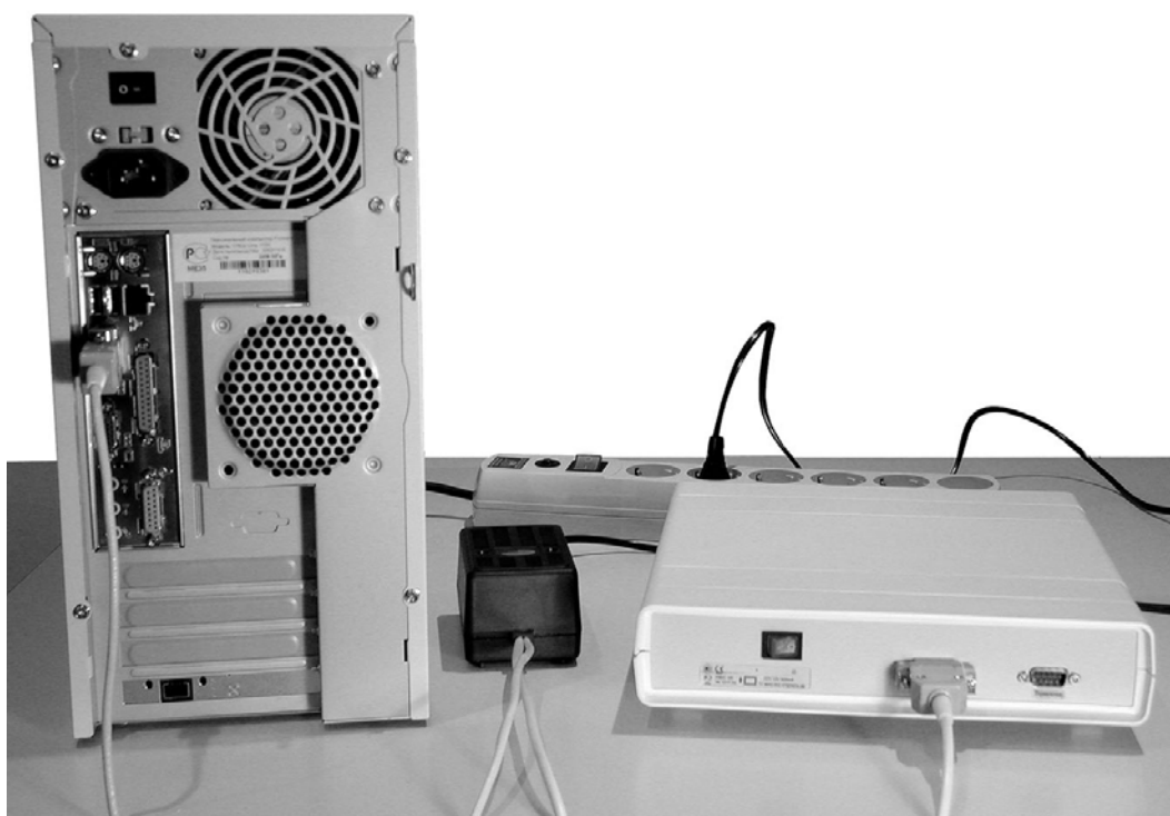
Рис. А 4. Преобразователь биосигналов и компьютер в сборе с блоком питания
