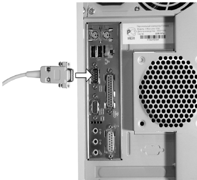
Рис. А 3. Задняя панель компьютера и 9-рип разъем блока питания
