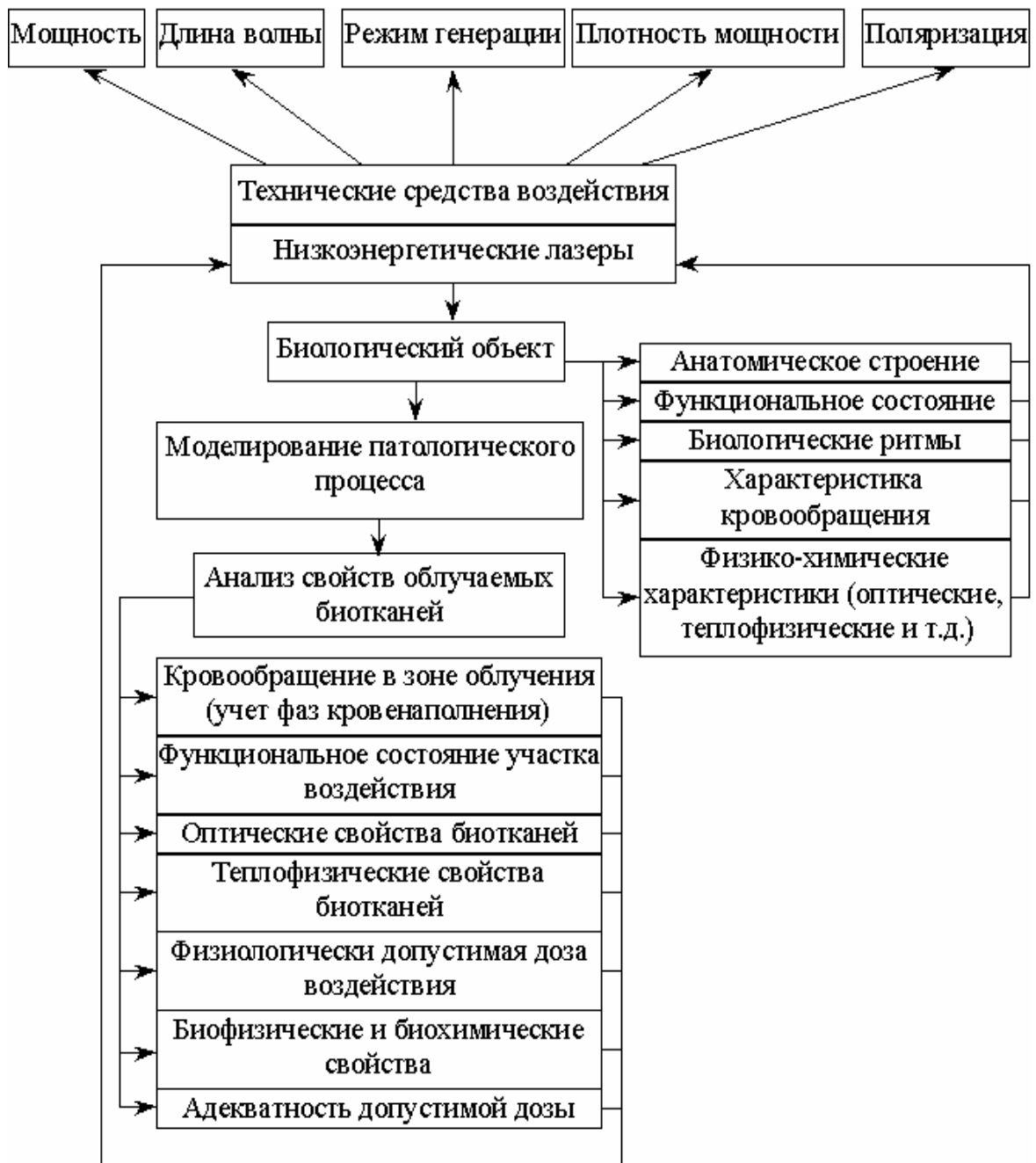
Рис. 1.3. Биотехническая система терапевтического воздействия низкоинтенсивным лазерным излучением
