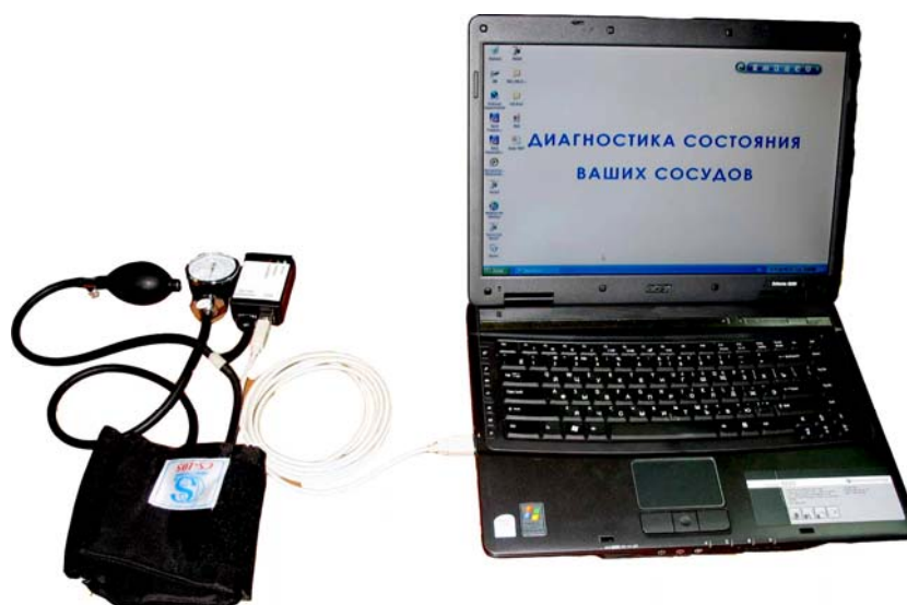
Рис. 4.6. Внешний вид устройства для оценки потенциальной опасности коллапсоидных осложнений при физических нагрузках
