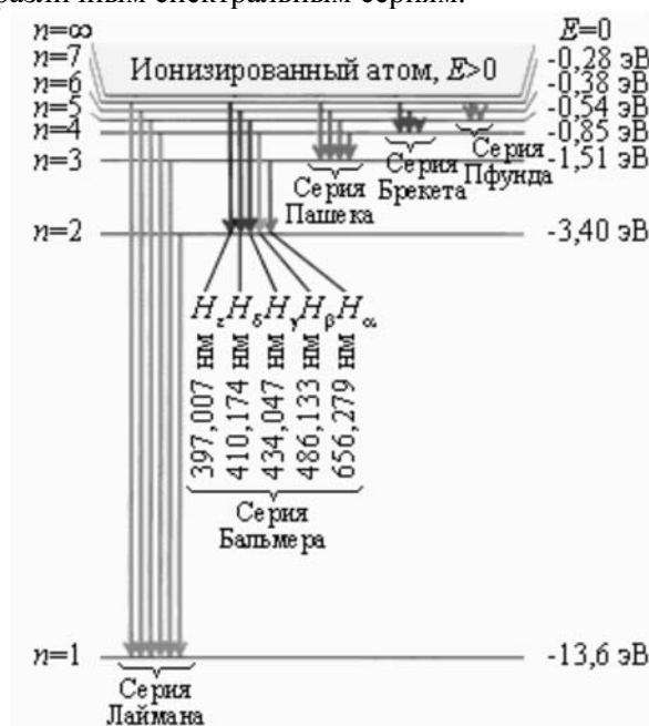
Рис. 36. Диаграмма энергетических уровней атома водорода.
