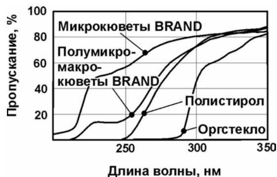
Рисунок 105. Спектры пропускания пластиковых кювет
