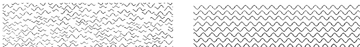
Рис. 87. А - некогерентный световой пучок, Б – когерентный пучок лазерного излучения
