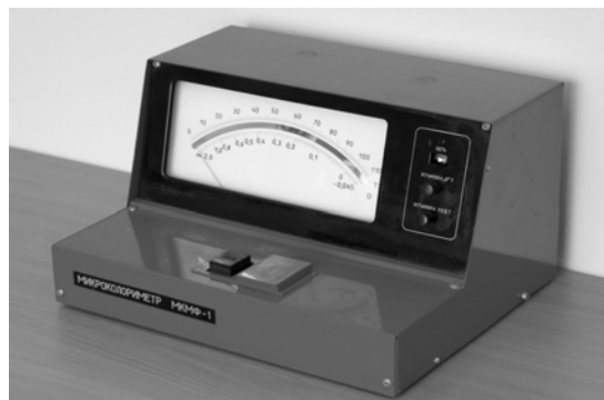
Рис.116. Микроколориметр МКМФ-1: оптическая схема и внешний вид.
