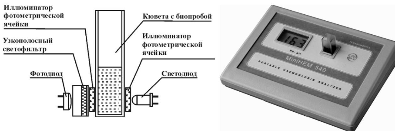
Рис. 122. Гемоглобинометр МиниГЕМ - оптическая схема и внешний вид.
