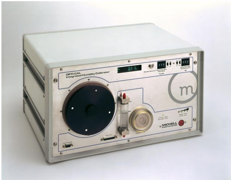
Обеспечивает регулирование по замкнутому циклу температуры и относительной влажности. Может быть достигнута общая погрешность измерения лучше чем 1,35% от измеренного значения относительной влажности, со встроенным базовым гигрометром
