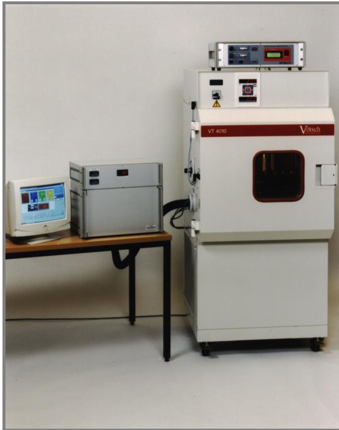
Это полностью автоматическая управляемая компьютером система калибровки для различных типов датчиков влажности в диапазоне  $-40...+40$  °C и 1... 98 % ОВ.
