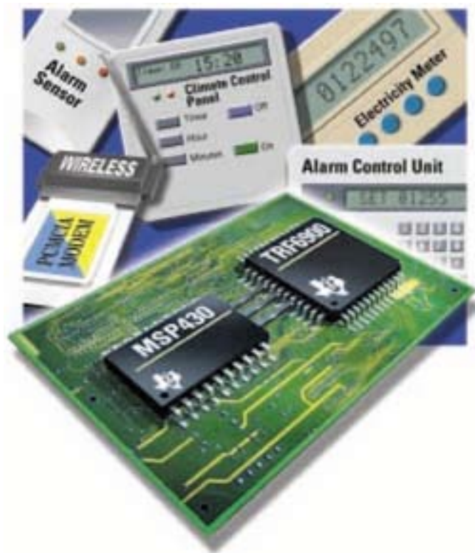
Беспроводная связь с помощью TRF6903 для работы на 315, 433, 868 и 915МГц
