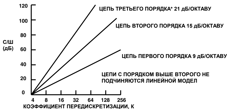
Рис.8.24. Зависимость отношения сигнал-шум от коэффициента передискретизации для цепей первого, второго и третьего порядков.
